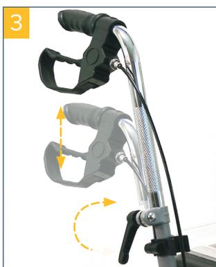
Schiebegriffe mindestens bis zur „MAX“-Markierung in das Rahmenrohr einstecken (**Bild 3**). Durch Drehen des Feststellhebels im Uhrzeigersinn in der gewünschten Höhe feststellen. Beide Griffe in gleicher Höhe einstellen.
