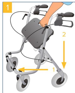
Rollator auf die Räder stellen. Vorderrahmen nach vorne drücken indem ein Handgriff schräg nach unten hinten gezogen wird, bis der Rollator auf vier Rädern steht.
